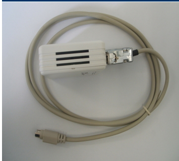
SM_T_COM – Temperatursensor zum direkten Anschluss an den COM 2-Port des SNMP-Adapters CS141
