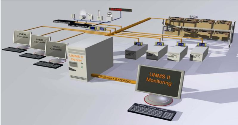
Bild: Prinzip des UNMS-Servers: Über die LAN-Verbindung werden die Daten aller Geräte wie USVs, Wechselrichter, Gleichrichter, Batterien, usw. auf den Server übertragen. Durch ein Upgrade des UNMS-Servers mit einer TELESERVICE-Lizenz, ist es möglich weitere Geräte über Remote LAN über einen VPN- oder GSM-Router zu verwalten. Mit dem Teleservice E-Mail-Trap lassen sich regelmäßige E-Mail-Nachrichten auf den UNMS-Server senden.
