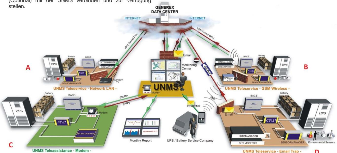
UNMS in der Version DATASERVER + TELESERVICE – 4 Verbindungsarten, davon 2 über das Portal GENEREX DATASERVER, welches für eine gesicherte Verbindung zwischen der UNMS und den Geräten beim Endkunden sorgt.
