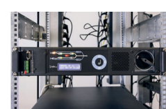
Modul festschrauben, nach dem Anlaufen manuellen Bypass zurücksetzen
