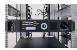
Modul festschrauben, nach dem Anlaufen manuellen Bypass zurücksetzen
